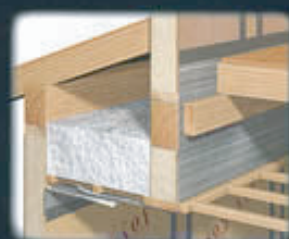
下屋廻りの、気密・断熱納まり
