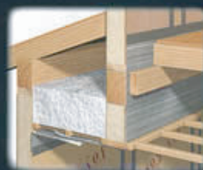
下屋廻りの、気密・断熱納まり
