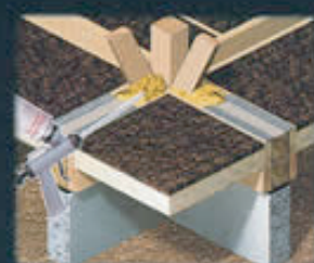
間仕切壁下部、気密・断熱納まり
