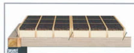
〈床パネル仮止め〉
