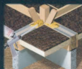
間仕切壁下部、気密・断熱納まり
